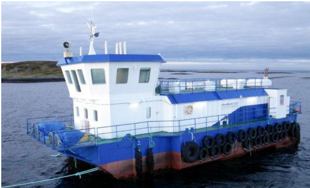
Mynd 3. Dæmigerður fóðurprammi, með stjórnstöð og stafsmanaaðstöðu. Fyrirhugað er að staðsetja slíkan pramma innan eldissvæðis, við kvíabyrpingu. Frá fóðurpramma er fóðrinu dælt út í eldiskvíar með háþrýstilofti gegnum plaströr.
